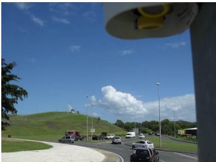
Figure 31 : Echantillonneurs passifs installés sur un site de mesure : rond-point Belle Vie - Nouméa
